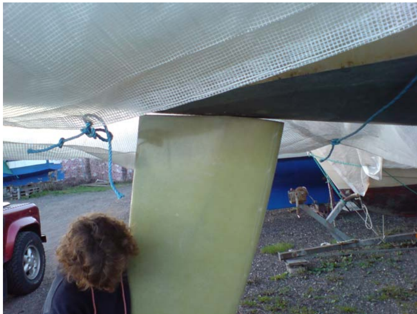
Roret prøvemonteres, og overkanten tilpasses undervandsskroget.
